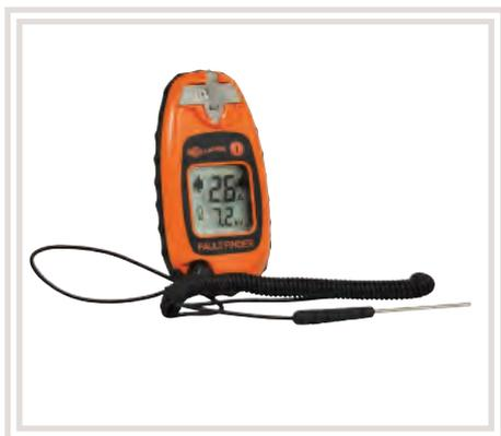
Individua i guasti in modo rapido e semplice qualunque sia il tipo di cavo o elettrificatore utilizzato. L'ampio display LCD mostra la tensione e la corrente. La freccia mostra la direzione del guasto.
