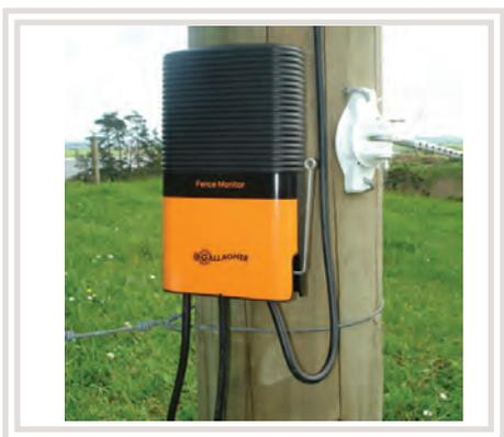
Consente di monitorare la recinzione e di ricevere un avviso in caso di malfunzionamento.
