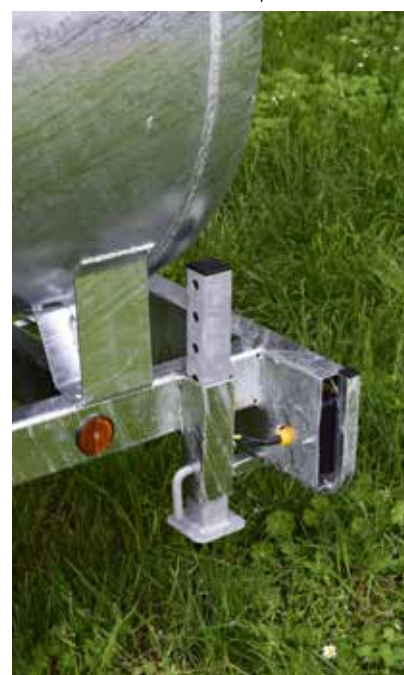
Béquilles stabilisatrices en partie arrière pour les modèles 1000 litres.
