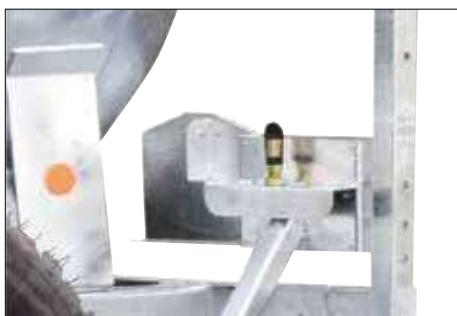
Câblage protégé. Prise gyrophares arrière.
