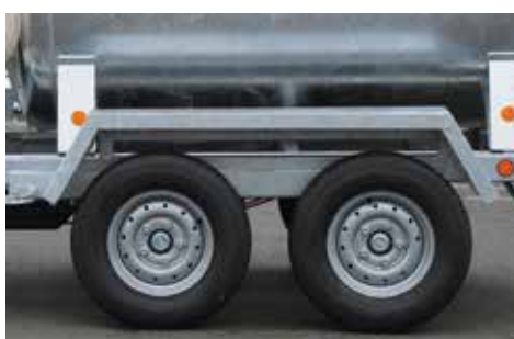
Double essieux pour les modèles 2000 litres avec garde-boue tôle.
