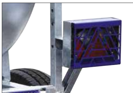
Feux protégés par grille métallique.
