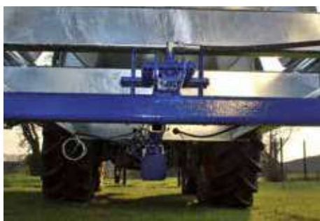
Essieu freiné à partir du modèle 1500 l.
