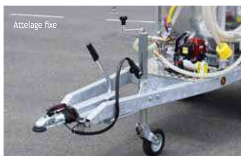
Attelage fixe équipé d'une tête d'attelage à freinage par inertie sur les modèles 1000 et 2000 litres.
