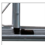
Taquets embarqués fabriqués en nylon injecté faisant office de mécanisme de blocage. En position blocage, le manchon de la barre mobile vient au contact du taquet. Système extrêmement silencieux.
