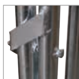
Axe de balancier renforcé guidé dans un fourreau.
