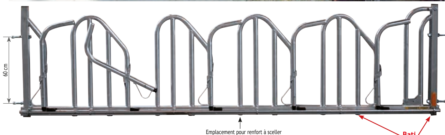
Barres mobiles avec manchon coulissant à l'intérieur faisant effet de protection anti-passage de collier. Manchons fabriqués en nylon injecté.
