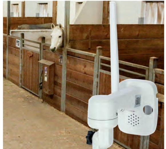
Dotazione: 1 IPCam SIM FHD, 1 alimentatore a 230 Volt, 1 antenna di ricezione, 1 cavo patch
