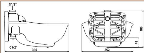
Il coperchio sul lato inferiore della bacinella e la struttura chiusa nella zona dell'alimentazione valvola hanno un effetto isolante e prevengono la dissipazione del calore rilasciato dal cavo riscaldante.
