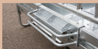
Aggancio a tre punti (con staffa di protezione)
