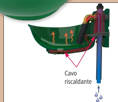
Il coperchio sul lato inferiore della bacinella e la struttura chiusa nella zona dell'alimentazione valvola hanno un effetto isolante e prevengono la dissipazione del calore rilasciato dal cavo riscaldante.
